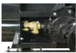
Modeller för upp till 2 000 varvs PTO. Brytbult skyddar inmatningen.
