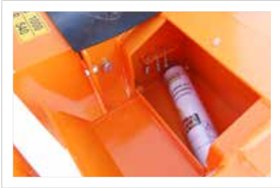
Verktøyglåda med hållare för brytbultar är standard på samtliga HD- och hydrauldrivna modeller. Plats för brytbultar, nyttiga verktyg, smörjutrustning med mera.
