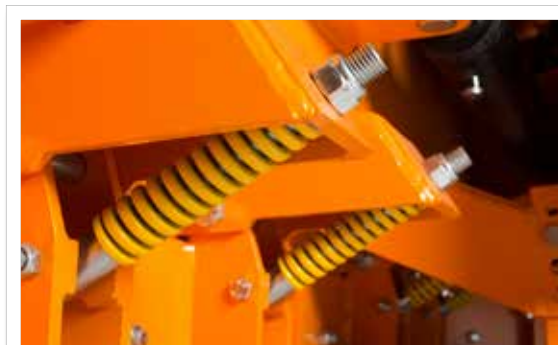
Fjädrande och vändbara slitstål som viker undan vid påkörning av fasta föremål.
