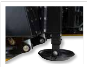
Slitkor i Hardox® som standard. Stödhjul finns som tillval.
