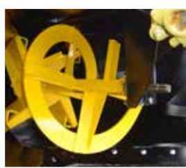
Stödhjulen (tillval) monteras bakom stödfoten på modell 245-P-HY och 245-2-HY.
