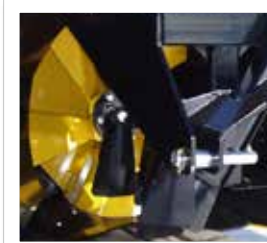
Trejon Optimal 245-P-HY är på bilden utrustad med en breddningsvinge. Hydraulisk klaffreglering levereras som standard.
