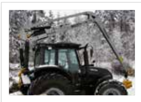
Med JAKE-ram monteras kranen på traktorn.
