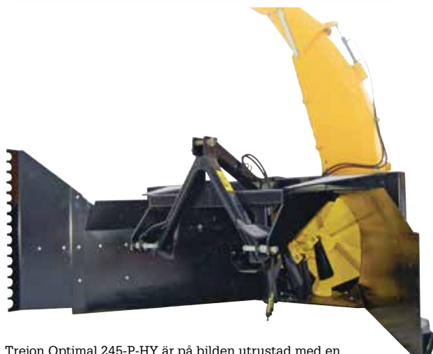
Trejon Optimal 245-P-HY är på bilden utrustad med en breddningsvinge. Hydraulisk klaffreglering levereras som standard.
