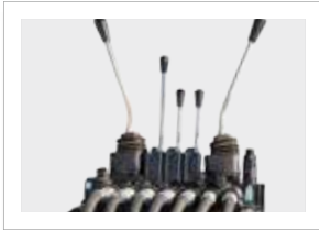
Standard ventilkpaket, "flerspaksventil". Vikt ca 20 kg.
