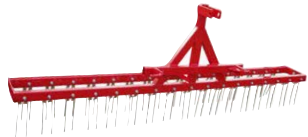
GK-200, med 33 st dubbelpinnar, passar utmärkt för grusgångar med mera. Pinnarna är 25 cm långa och har en diameter på 6 mm.
