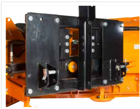
Redskapsfäste med flytlägesfunktion finns som tillval till VP210-320.
