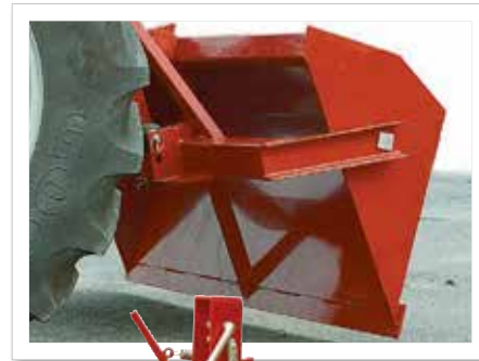
Skopor för 3-punktsmontage. Bilden till vänster visar modell T-220, den undre modell T-200.
