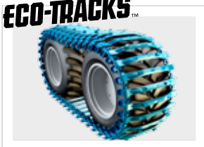
ECO-Trackband, finns i olika utföranden samt för olika däckdimensioner. Kontakta oss för ytterligare information.
