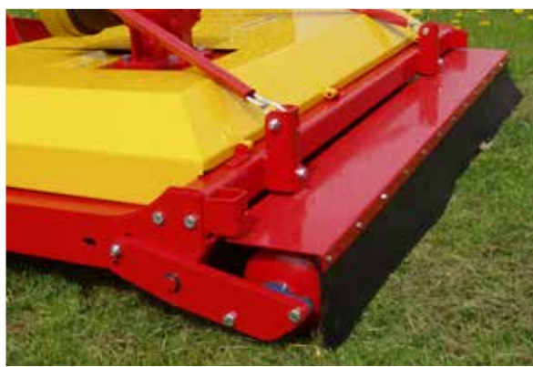
Stödrolle, alternativ tillvalsutrustning för bättre markanpassning.
