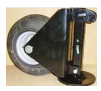
Stödhjulen (tillval) monteras bakom stödfoten på modell 245-P-HY och 245-2-HY.
