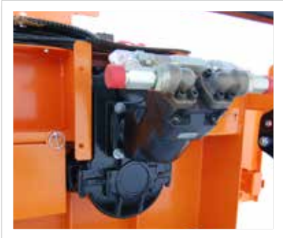
Hydraulmotor av koltyp är direktmonterad i växellådan. Anpassad för höga tryck och kontinuerlig drift. Avser modell 1802H–2452H.
