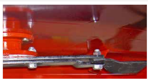
Kniven har en kraftig infästning med dubbla knivhållare, för att klara större påfrestningar.
