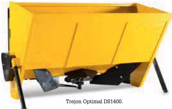
3-punktskopplingen är integrerad i den bakre väggen på DS1200-1700. DS2500 har en integrerad Volvo BM-koppling.
